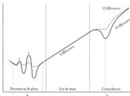
Fig. 31 Aislamiento de una pared simple.
