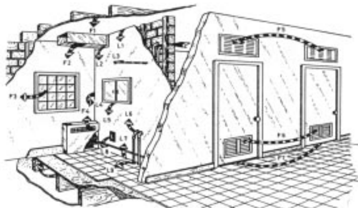
Fig. 35. Puntos críticos para asegurar la estanqueidad acústica.
