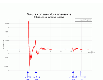
Figura 3 – Risposta impulsiva diretta e riflessa del materiale in prova
