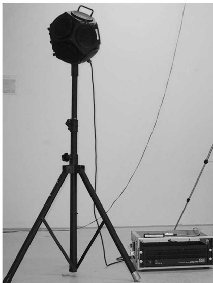
Kuva 16. Pallokaiutin (B&K 4296), signaaligeneraattori ja vahvistin (Neutrik MRI, QSC 1200 W).
