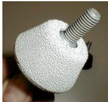
Fotos Realizadas por R. TORRES ; Patologías de amortiguadores de caucho-metal mal fabricados o diseñados.
